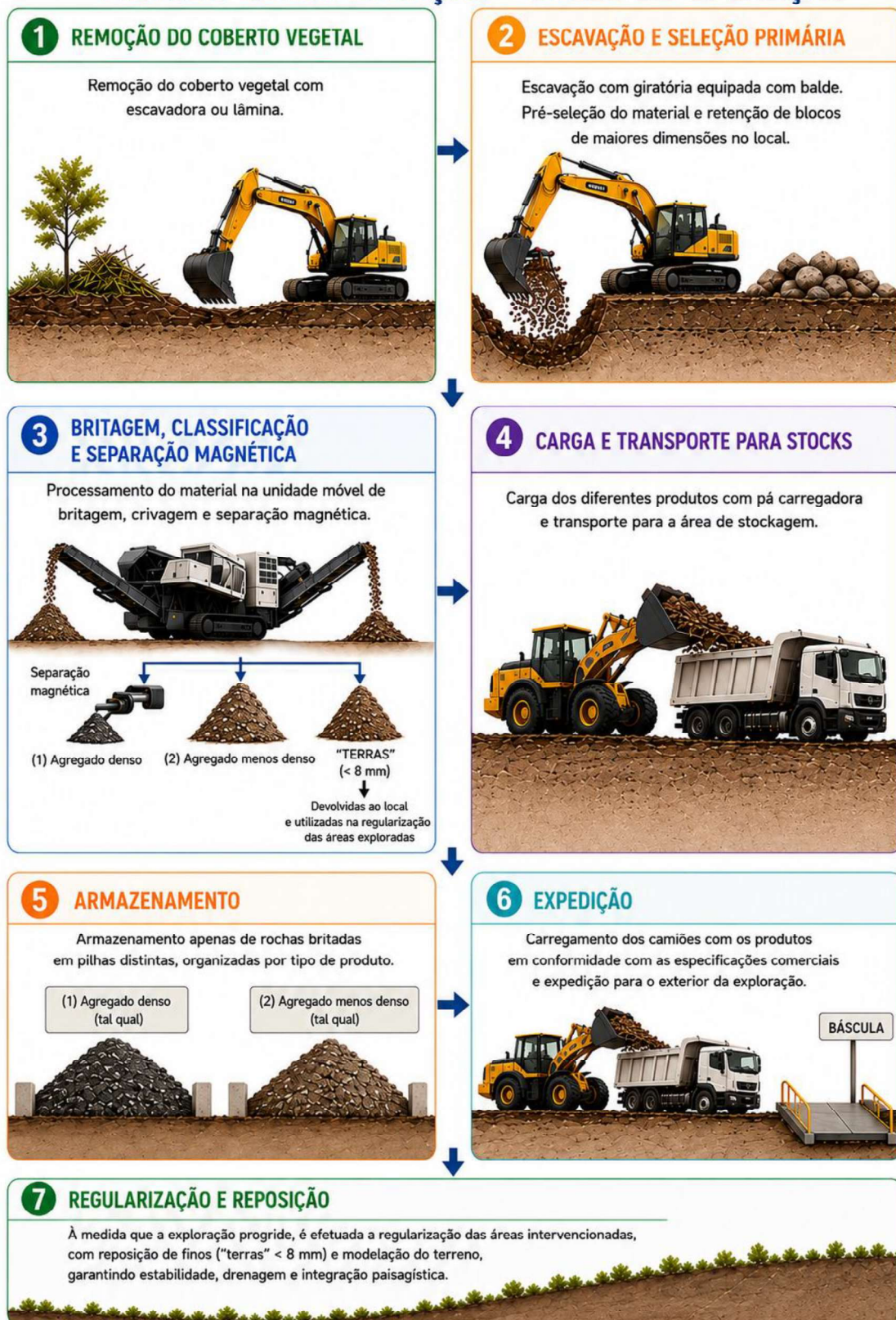
Figura 7.1 Ilustração das fases do método de exploração dos depósitos superficiais
