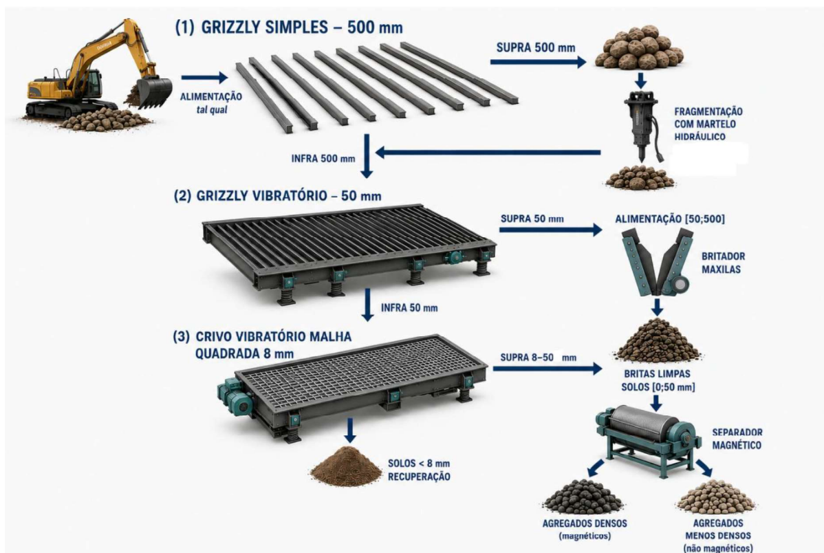
Figura 8.1 Fluxograma da unidade móvel de processamento composta por três crivos de separação (2 do tipo grizzly e um de rede), um britador de maxilas e um separador magnético de rolos
